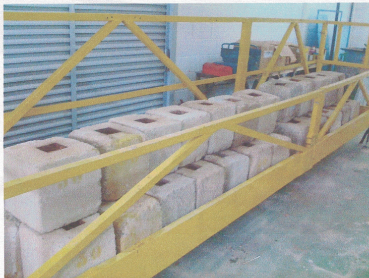
Figura 1: detalhe do apoio da plataforma no ensaio de carga mínima de ruptura
