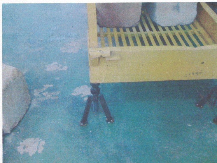
Figura 1: detalhe do apoio da plataforma no ensaio de carga mínima de ruptura
